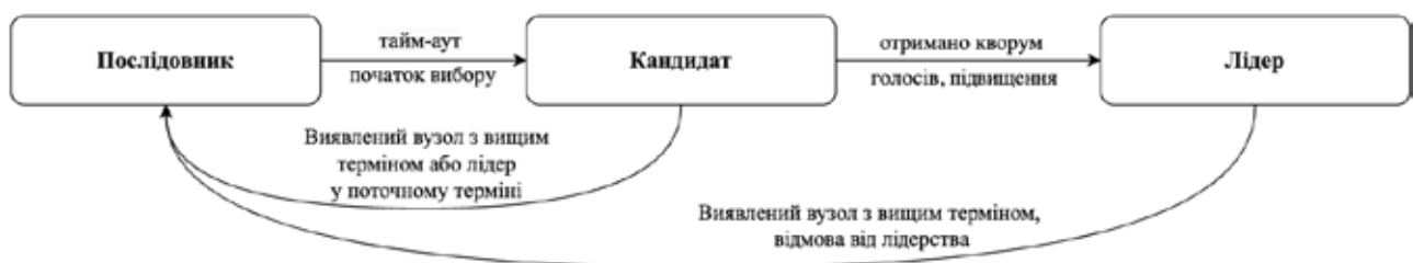
Рис. 1. Схематичне зображення алгоритму Raft
